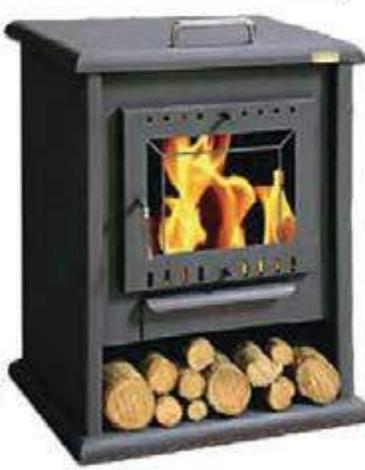
**JUAN PANADERO ESTUFA DE LEÑA MODELO SABINA CON HORNO.** Estufa de leña modelo SABINA con horno calentaplatos. Salida de humos posterior de 120 mm. Peso: 90 kg. Cuerpo en chapa de 4 mm. Horno en la parte superior. Cristal vitrocerámico: 750°C. Pintura anticorrosiva: 800°C. Potencia calorífica: 12,70 kw. Una estufa de grandes prestaciones con un diseño actual. Puerta entrada de leña 382x295 mm. Troncos hasta 52 cm.
