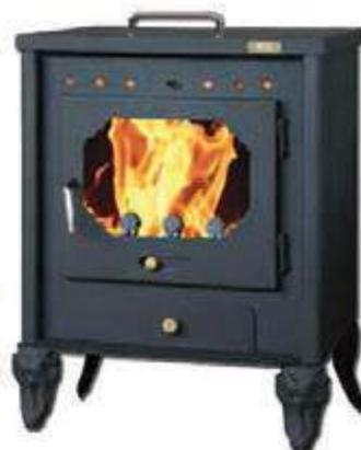
**JUAN PANADERO ESTUFA DE LEÑA MODELO NIZA CON HORNO.** Estufa de leña modelo NIZA con horno calentaplatos. Salida de humos superior de 120 mm. Peso: 52 kg. Cuerpo en chapa de 3 mm. Calientaplatos y amplio leñero en la parte inferior. Cristal vitrocerámico: 750°C. Pintura anticorrosiva: 800°C. Potencia calorífica: 10,50 kw. Estufa compacta con estilo propio que ofrece un alto rendimiento. Puerta entrada de leña 290x220 mm. Troncos hasta 40 cm.
