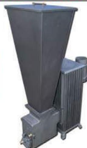
**CHIMENEAS REDONDO ESTUFA HUESO MODELO 100.** Estufa hueso modelo 100 fabricada en chapa de acero. Salida de humos de 100 mm. Potencia calorífica 18 kw. Pintura anticorrosiva: 650°C. Rendimiento neto del 72%. Emisión de CO: 0,38. Recomendable para todo tipo de biomasa, huesos de aceituna, pellets, cáscaras de almendras, de avellanas, de melocotón, etc...
