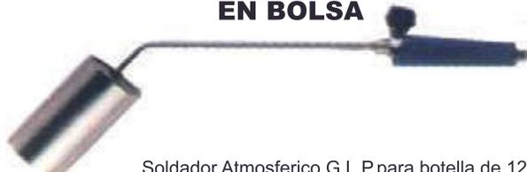
Soldador Atmosferico G.L.P. para botella de 12,5 kg, boquilla tipo chimenea C-70 potencia 70 KW = 60.200 calorías encendido con llama auxiliar, lanza de gran longitud (30 cm) mango ergonomico, regulacion de minimo con pomo en el mango
