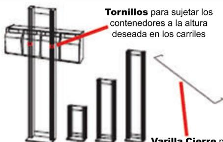
Tornillos para sujetar los contenedores a la altura deseada en los carriles
