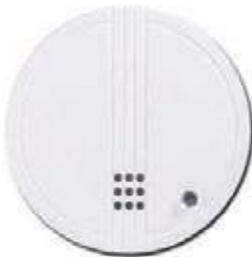
COMPUESTO POR UN CUERPO DETECTOR FORMADO POR UNA FUENTE DE LUZ (RADIACIÓN INFRARROJA MODULADA) Y UN DISPOSITIVO RECEPTOR FOTOSENSIBLE (FOTODIODO) CAPAZ DE DETECTAR LAS PARTÍCULAS DE HUMO. ESTÁ PREPARADO PARA EVITAR FALSAS ALARMAS, COMO EL HUMO DE LOS CIGARRILLOS. INCLUYE UNA FUNCIÓN DE TESTEO. PROTEGE UNA SUPERFICIE DE HASTA 20 m². IDEAL PARA CASAS, VIVIENDAS, CARAVANAS, ETC...
